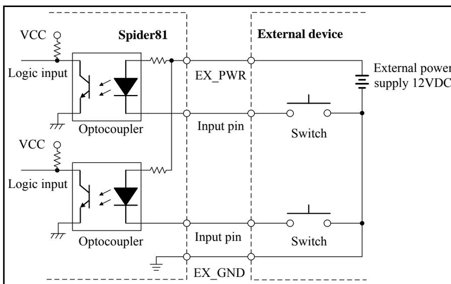
**Figure 30. Input Circuit**
